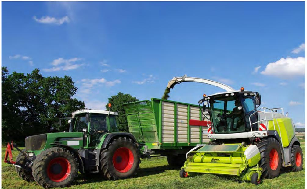
*Rechtzeitig vor der Ernte sollten ältere Feldhäcksler-Modelle sicherheitstechnisch nachgerüstet werden. Neue Modelle verfügen in der Regel schon über eine automatische Abbremsung der Häckselorgane oder vergleichbare Sicherheitseinrichtungen.*
